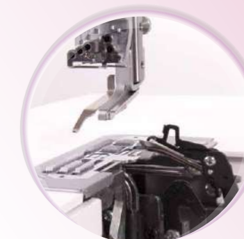
Boucleur surdimensionné avec boucleur auxiliaire intégré
