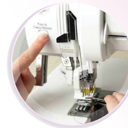
RevolutionAir™ Threading System Pour la première fois une recouvreuse avec enfileur d'aiguille
