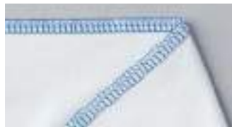
Surfilage 4 fils Utilisez 2 aiguilles et 4 fils pour coudre ensemble les matières extensibles.
